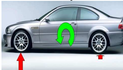
Figura 9: Trasmisión de peso durante frenada
