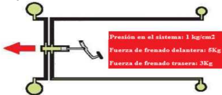
Figura 10: Distribución de fuerzas en el sistema de frenado
