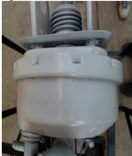
Figura 52: El Servofreno Hidrovac
