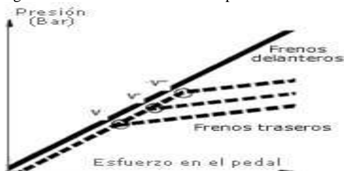
Figura 81: Curva de la relación de presión de frenado.
