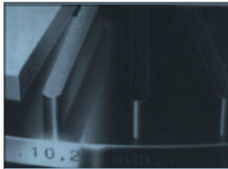
Figura 34: Corriente de aire en los discos de freno
