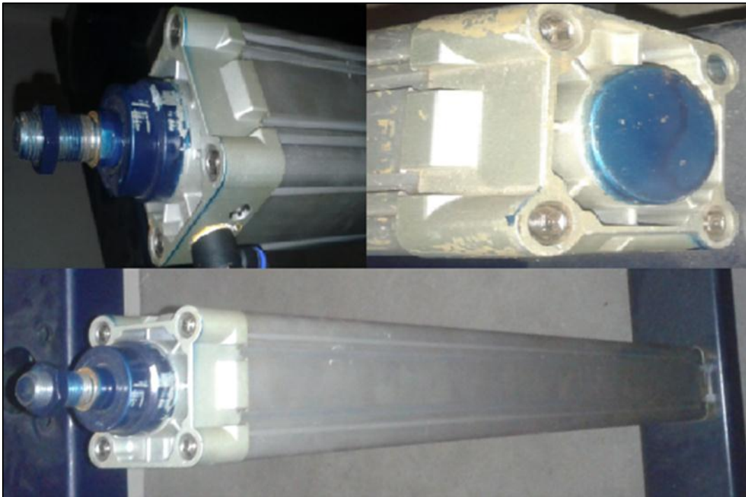
Figura 38. Cilindro neumático con topes magnéticos
