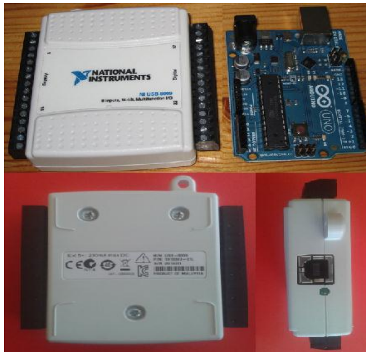
Figura 58. Tarjeta DAQ USB 6009
