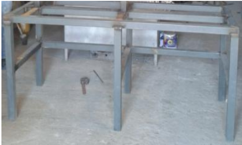
Figura 88. Mesa de sujeción con sus cordones de suelda
