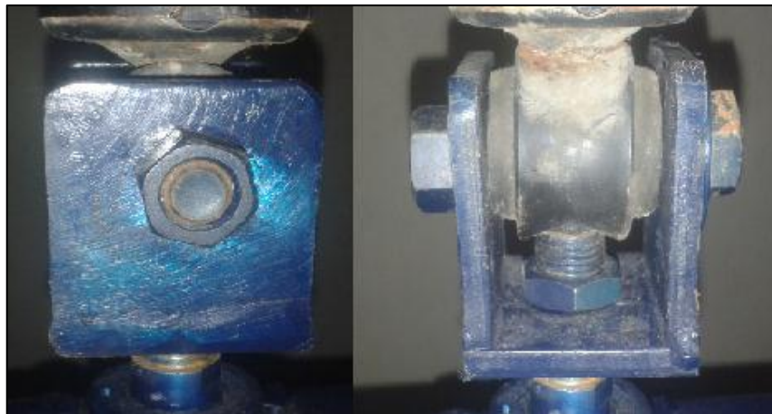
Figura 97. Soporte de sujeción del amortiguador en U
