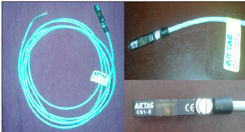
Figura 39. Sensor magnético CS1-E
