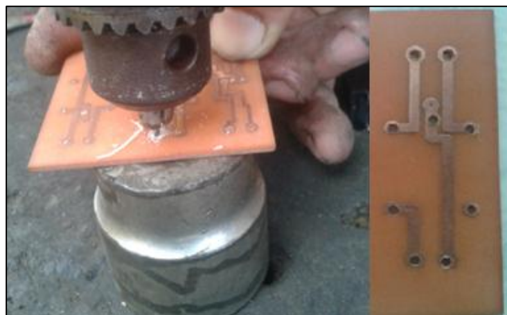
Figura 55. Perforación de la placa
