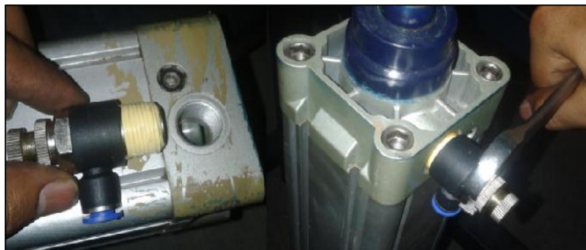
Figura 101. Colocación de los controladores de flujo-directo
