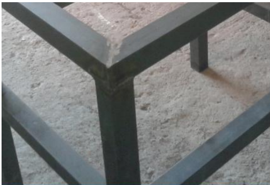
Figura 89. Retirada de escoria y pulida
