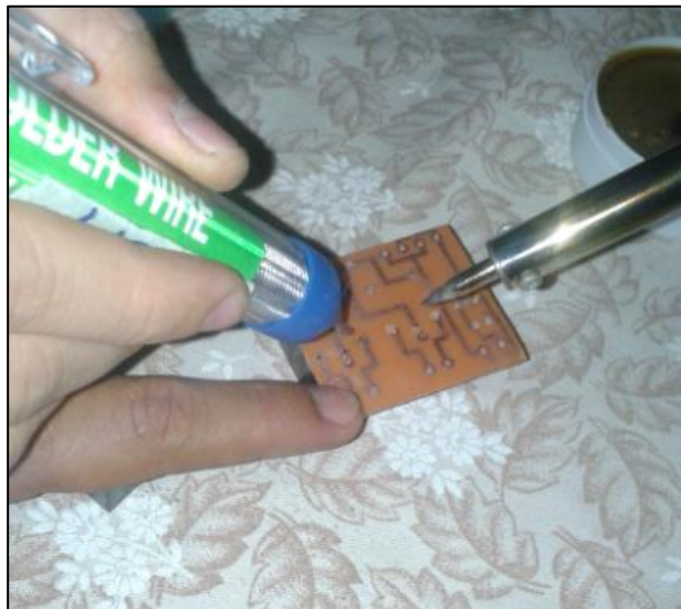
Figura 57. Soldando las diversas piezas en la placa
