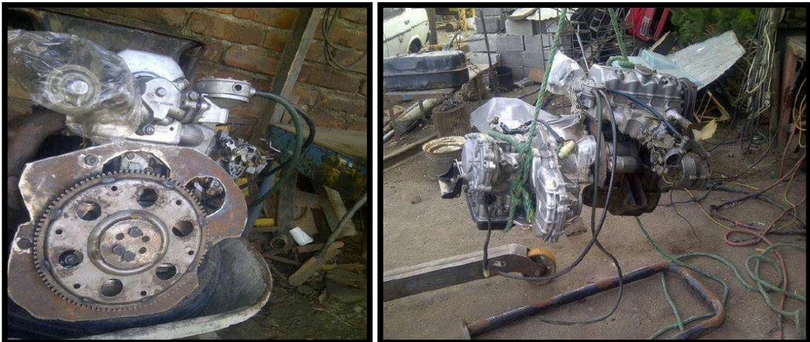
Figura 91. La caja automática fija al motor
