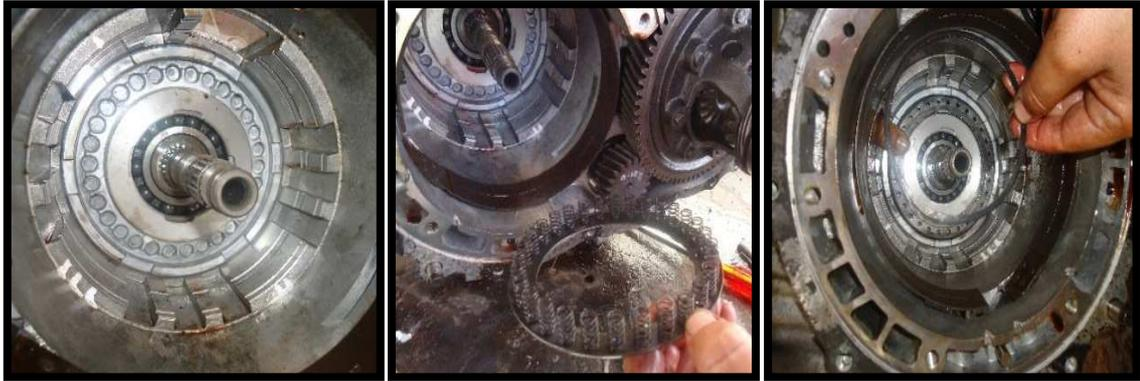
Figura 86. Instalación del freno de primera y retro
