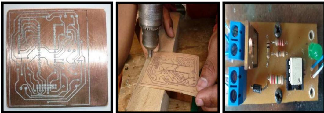
Figura 85. Elaboración de la placa electrónica
