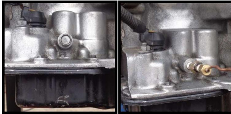
Figura 108. Prueba de presión
