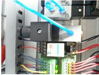
FIGURA. IV.28 VACUOSTATO<sup>103</sup>
