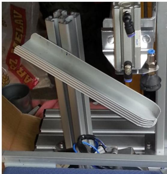
FIGURA. IV.11 SISTEMA DE ALIMENTACIÓN.<sup>86</sup>
