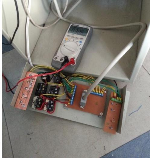
FIGURA. V.5 VERIFICACIÓN DE CONEXIONES DE LA BOTONERA<sup>110</sup>
