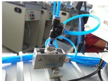
FIGURA. IV.29 GENERADOR DE VACÍO<sup>104</sup>
