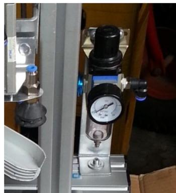
FIGURA. IV.30 UNIDAD DE MANTENIMIENTO.<sup>105</sup>
