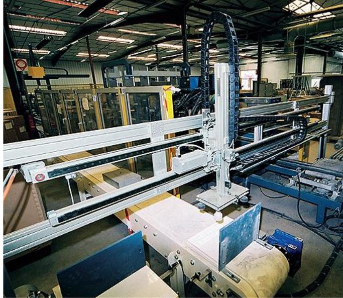
FIGURA. II.3 ESTACIÓN PICK AND PLACE EN LA INDUSTRIA<sup>4</sup>
