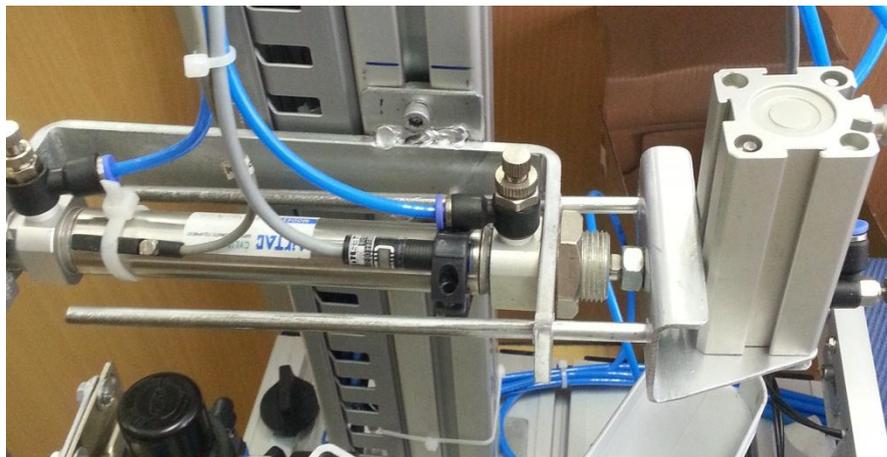
FIGURA. IV.0.20 SENSORES A0, A1<sup>95</sup>
