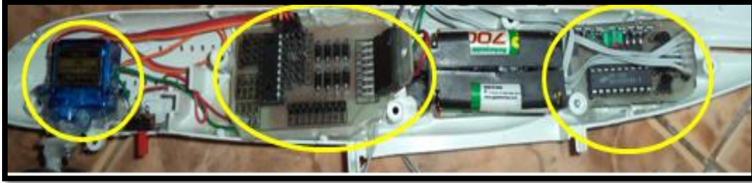
Figura V-7 Microservo, Microcontrolador, Puente H y Receptor ubicados en el Avión a Escala alimentados por el banco de pilas en serie 83
