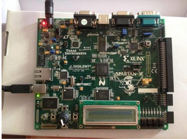
**FIGURA IV.45:** Conexión a la fuente y el cable USB
