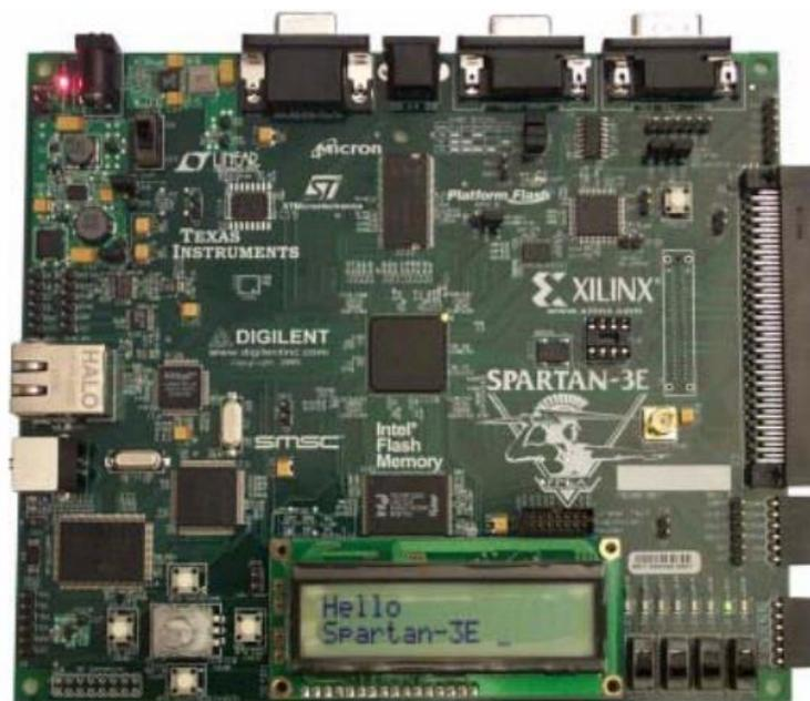
**FIGURA III.1:** Tarjeta Fpga Xilinx Spartan 3e Fpga (500k Gates)
