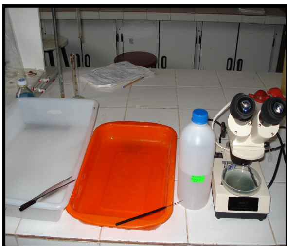
Foto 16. Materiales y equipos necesarios para la identificación de macroinvertebrados en el laboratorio Fuente: Saransig, R. (2008)
