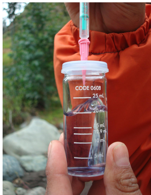
Foto 7. Determinación de la alcalinidad en el campo Fuente: Saransig, R. (2008)
