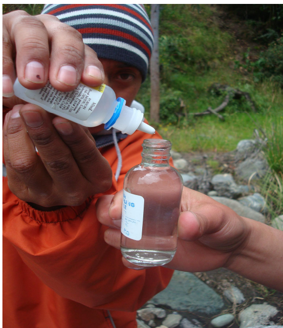
Foto 6. Determinación del oxígeno disuelto en el campo Fuente: Saransig, R. (2008)
