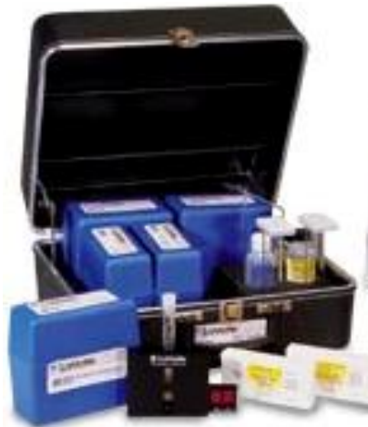
Figura 6. Kit portátil marca "LaMotte" para la medición de los parámetros físico-químicos in situ .
