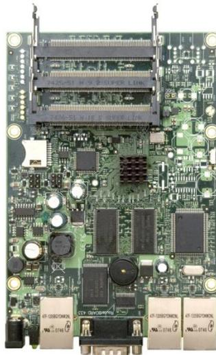
Figura IV.4. Routerboard Mikrotik RB433AH.
