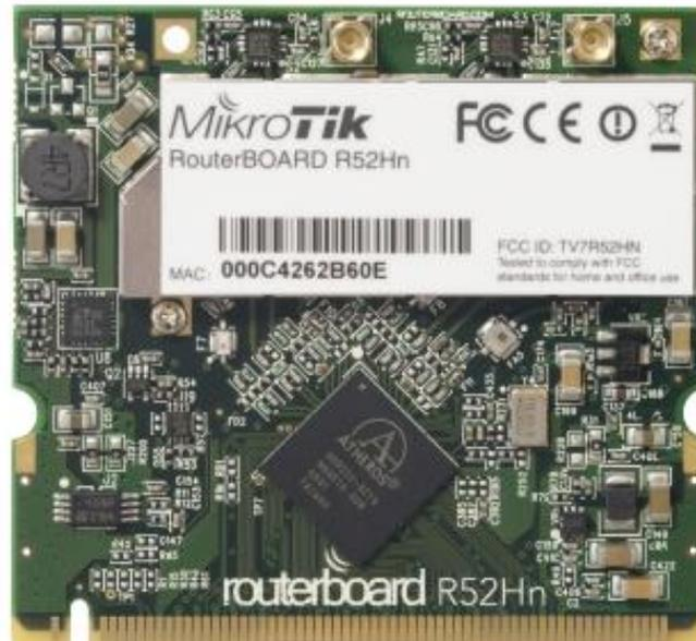
Figura IV.7. Tarjeta Mini-PCI R52Hn.
