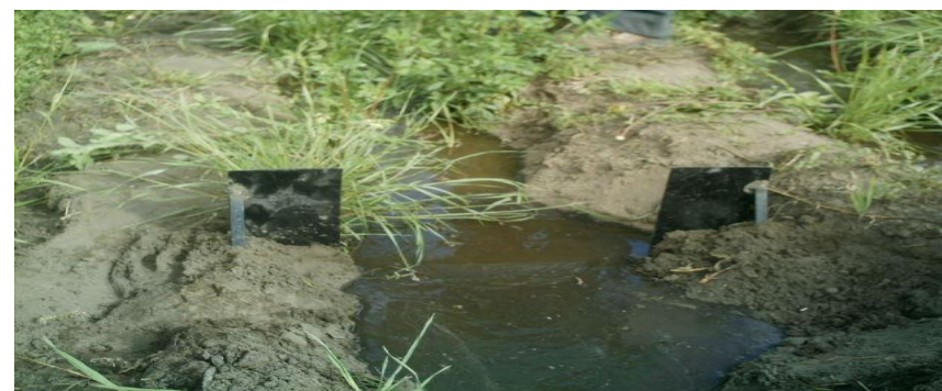
FOTO 16: Medición del agua en vertedero.
