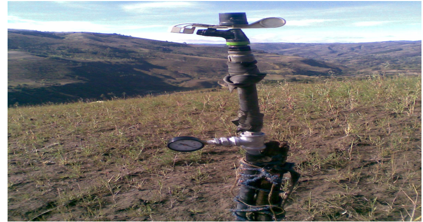
FOTO 18: Medición del presión con manómetro aspersor senniger.
