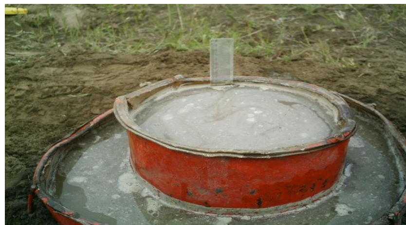
FOTO 14: Medición del descenso de agua en el cilindro.
