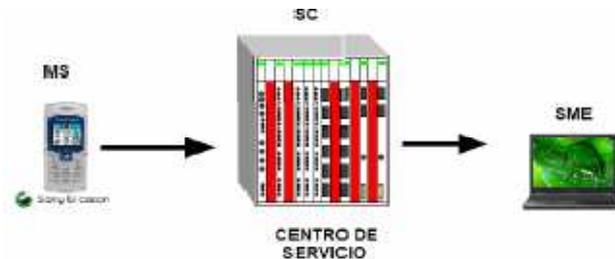
**Figura 10.** Envío de un SMS entre una MS y una entidad fija
