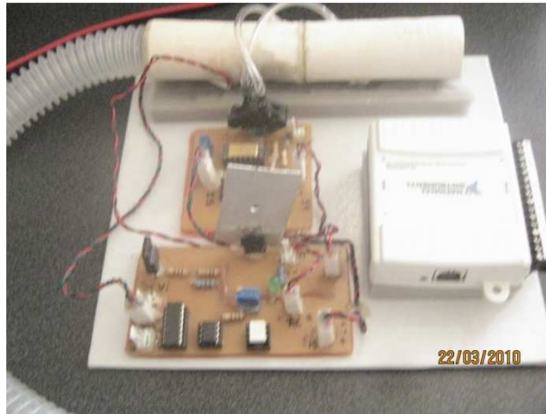
Figura IV.31 Conexión física del sistema electrónico de adquisición de datos
