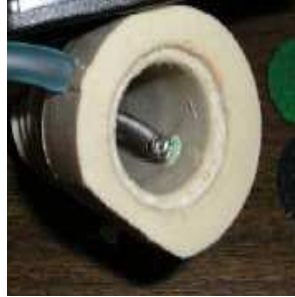
Figura IV.23 Colocación de la resistencia neumática
