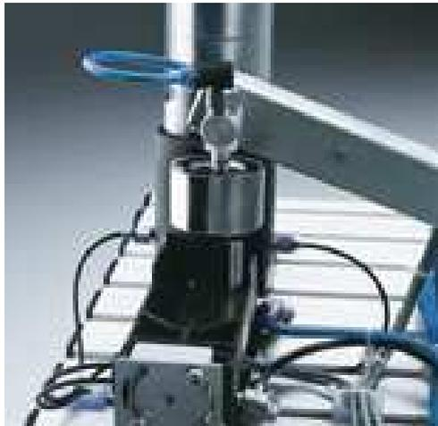
**Figura N° IV.23.** Actuador Semi- giratorio
