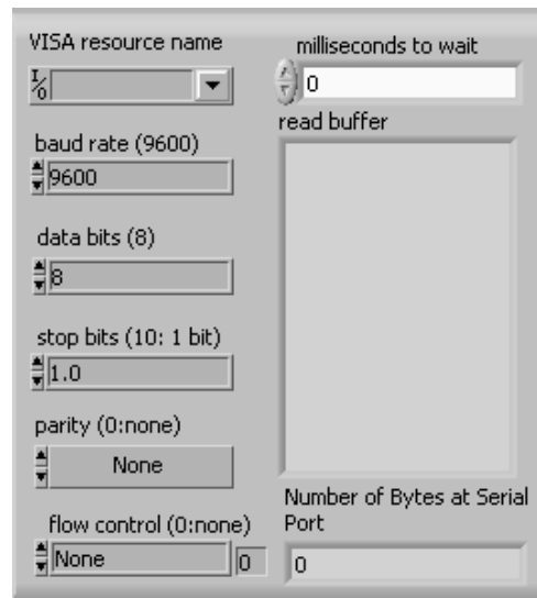
Figura XXXII.33 Tablero de control de flujo de datos
