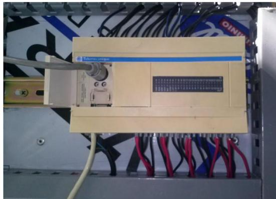
**Figura IV-39 Implementación del PLC Telemecanique<sup>78</sup>**
