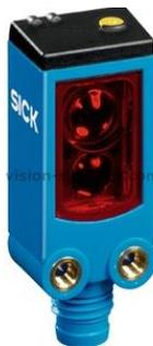
**Figura IV-15 Sensor con Supresión de fondo<sup>54</sup>**
