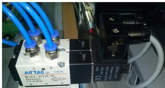
Figura IV-33 Implementación de Válvulas<sup>72</sup>
