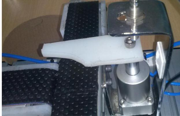
**Figura IV-30 Implementación del Cilindro de Giro<sup>69</sup>**
