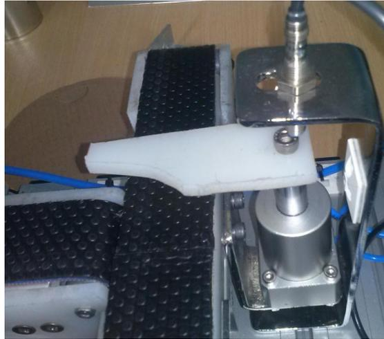
**Figura IV-14 Implementación del Sensor Inductivo<sup>53</sup>**
