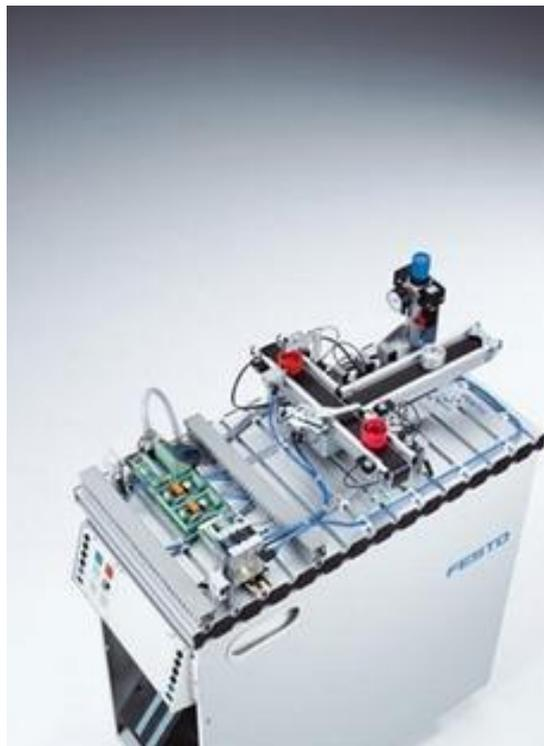
**Figura II-4 Estación de Separación<sup>4</sup>**
