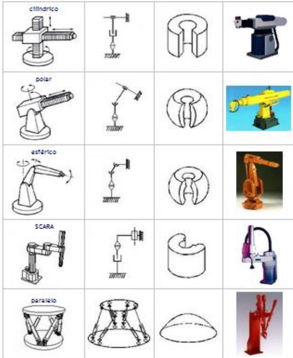
**Fig. II 3.** Principales configuraciones de un Robot 2.
