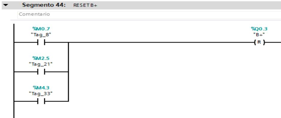
**Fig. III 60.** Programación RESET.
