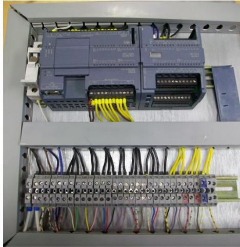
**Fig. III 48.** Cableado del PLC.
