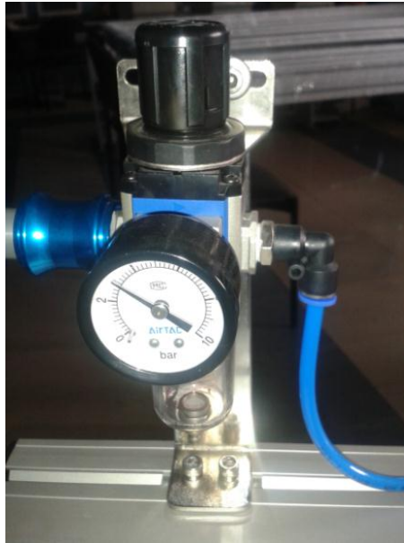
Figura IV.63 Unidad de Mantenimiento del Sistema Neumático. 69
