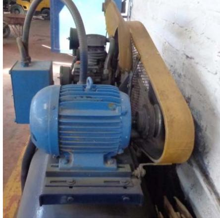
**FIG. IV. 27. Motor del compresor de Aire**
