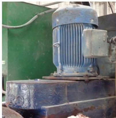
FIG. IV. 24. Motor que activa las paletas de mezclado
