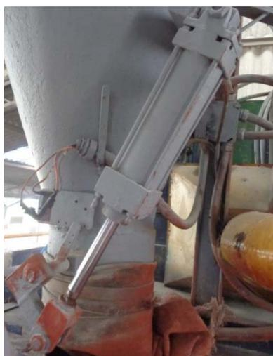
**FIG. IV. 40. Cilindro ubicado en el silo de cemento**
