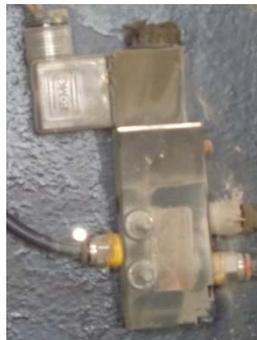
**FIG. IV. 42. Electroválvula del cilindro que abre la válvula de agua**
