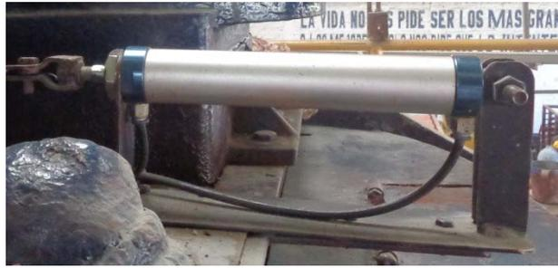
**FIG. IV. 41. Cilindro que permite el aporte de agua**
