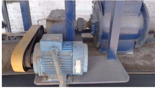
**FIG. IV. 29. Motor de las bandas secundarias bajo silos**
