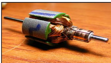
**FIG. III. 5. Rotor de un motor DC**
