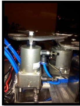
Figura IV-64. Montaje del cilindro de expulsión CEP 106
