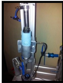
Figura IV-62. Montaje del cilindro del taladro CT 104
