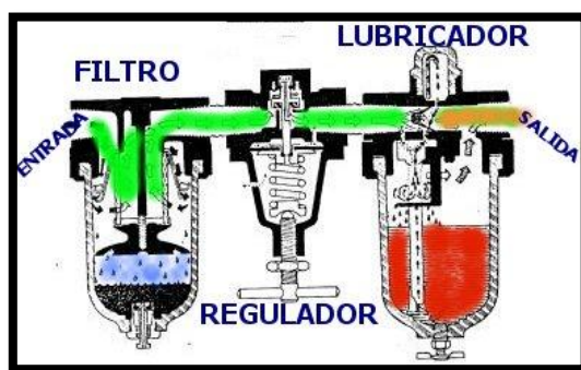
Figura III-31. Funcionamiento de la Unidad de Mantenimiento Neumática 64
