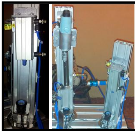
Figura IV-63. Montaje del cilindro de verificación CV 105
