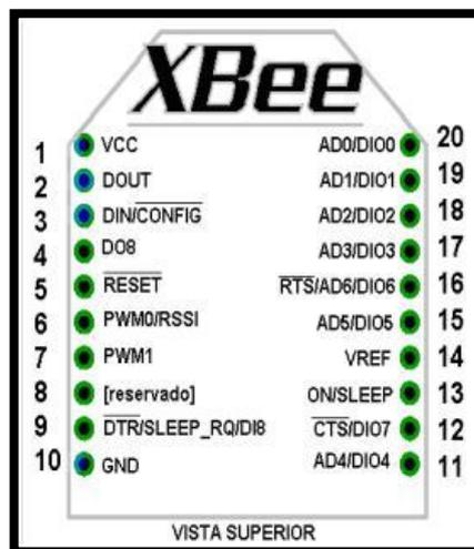
**Figura IV.74 : Pines del Xbee S1**
