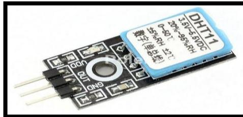
**Figura IV.68: Sensor DHT11**
