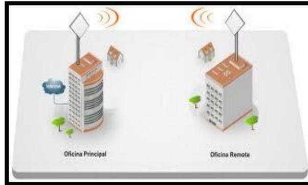
**Figura II.30: Conexión punto a punto**
