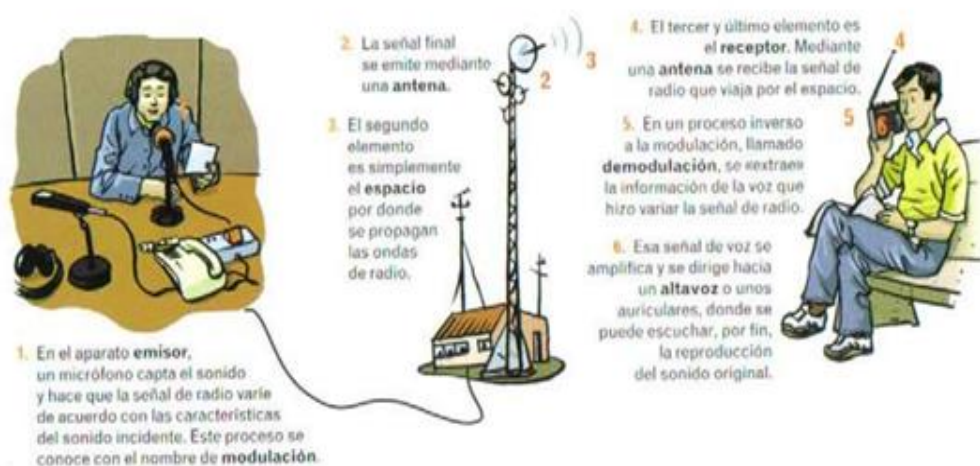
Figura II. 3 Funcionamiento de una estación de radiodifusión FM
