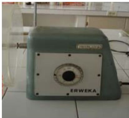
FOTOGRAFÍA No 20. CONTROL DE FRIABILIDAD Y DESINTEGRACIÓN EN LOS COMPRIMIDOS FITOFARMACÉUTICOS REALIZADO EN LA PLANTA PILOTO UNIVERSIDAD CENTRAL DEL ECUADOR. DICIEMBRE 2012
