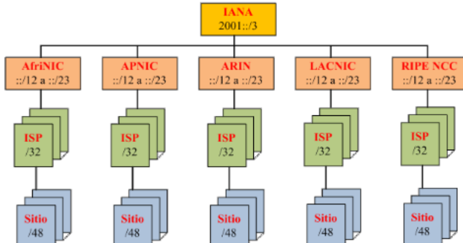
Figura II. 7 Jerarquía de Direcciones Unicast Globales. Fuente: Direcciones "unicast" Globales (Ramírez Mosquera Danilo Enrique, 2010)
