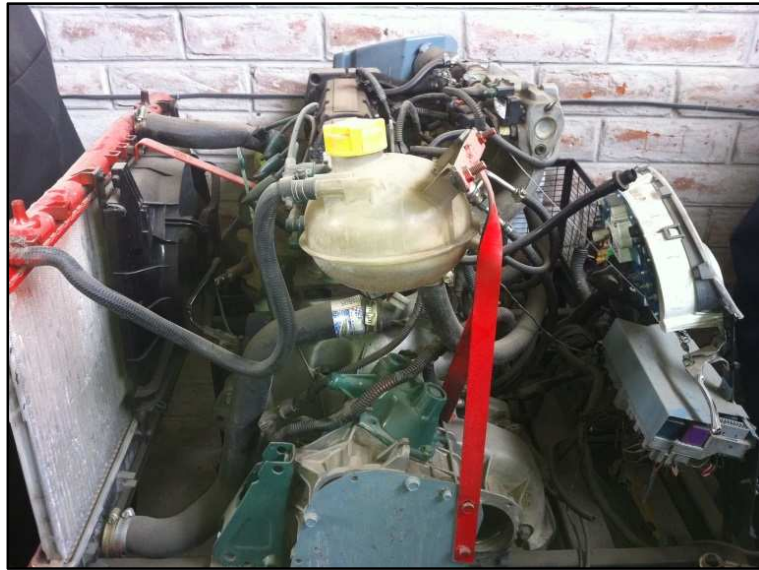
Figura 27. Estado actual del motor C14SE
