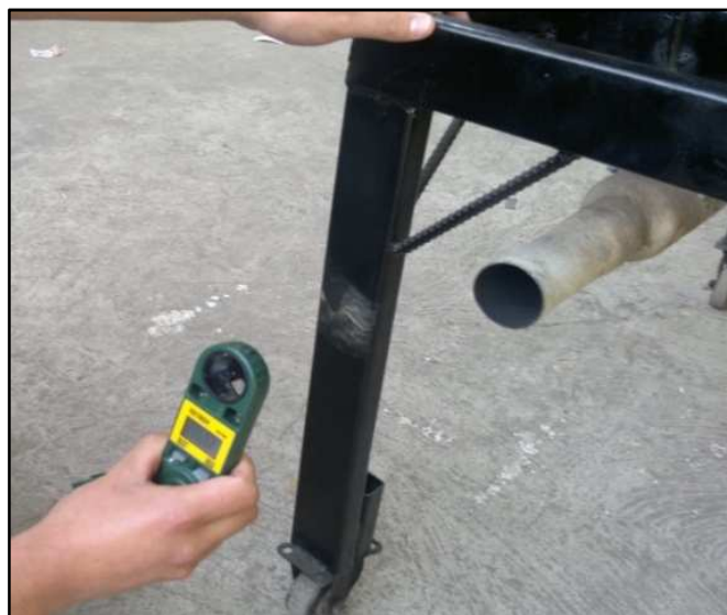
Figura 45. Toma de datos de velocidad usando anemómetro
