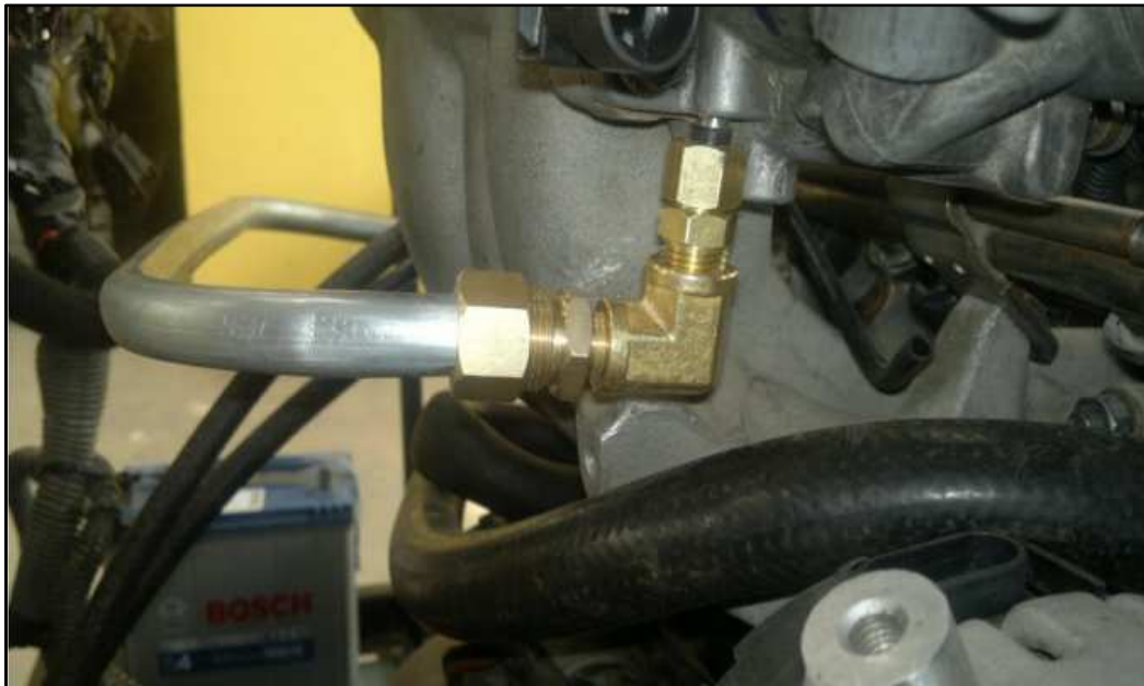
Figura 72. Adaptación de la tubería en el colector de admisión
