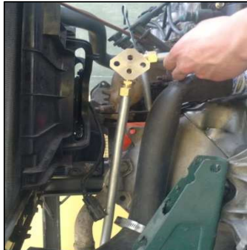
Figura103. Comprobación de tuberías y racores
