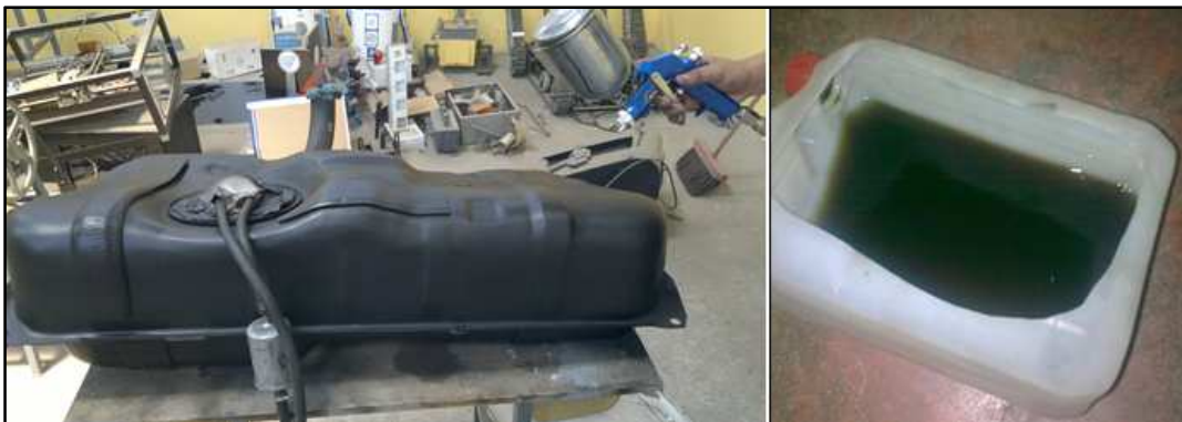
Figura 28. Limpieza del depósito de combustible
