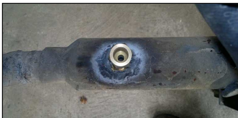
Figura 95. Adaptación del tubo primario de escape
