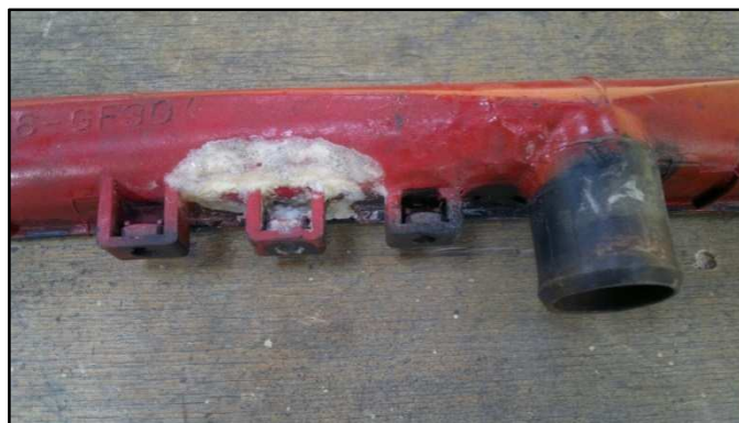
Figura 32. Tapa superior del radiador roto
