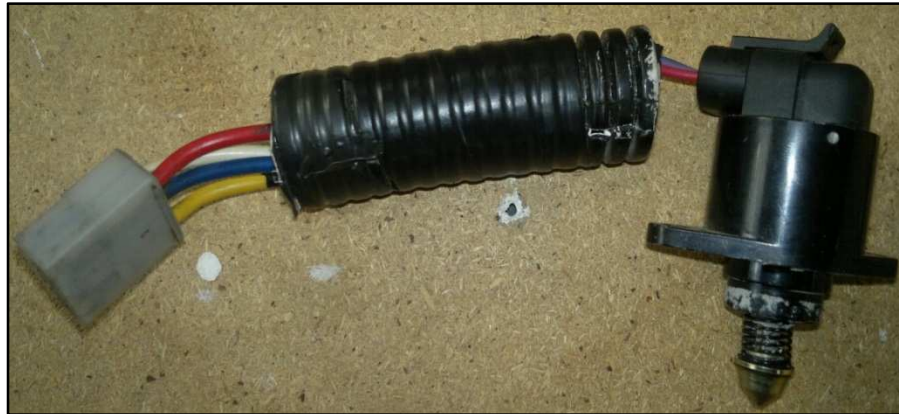
Figura 35. Válvula de control de marcha mínima
