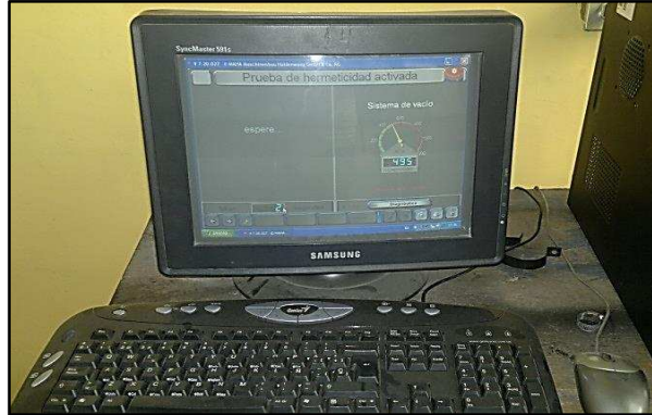
Figura 84. Test automático de hermeticidad del equipo MGT - 5
