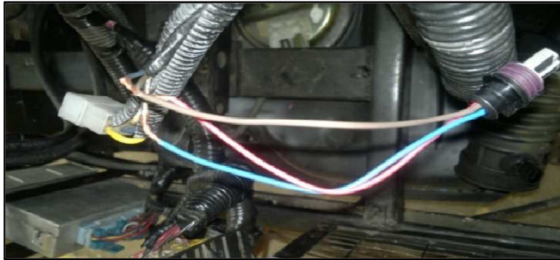
Figura 33. Revisión de conexionado de sensores y actuadores
