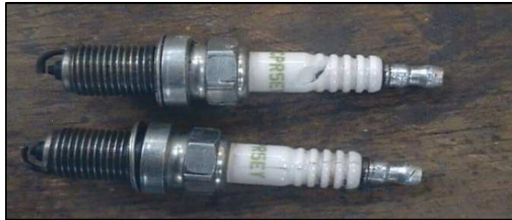
Figura 31. Bujías de encendido rotas
