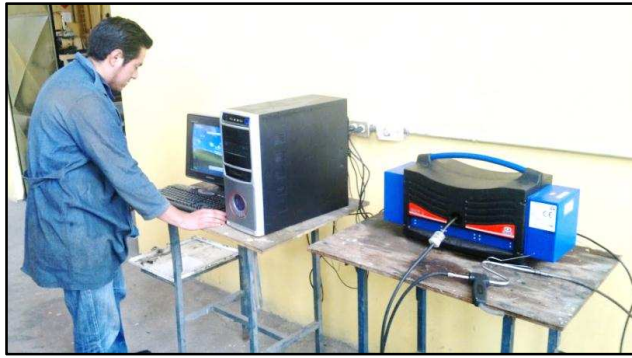
Figura 82. Instalación del equipo analizador de gases MGT – 5
