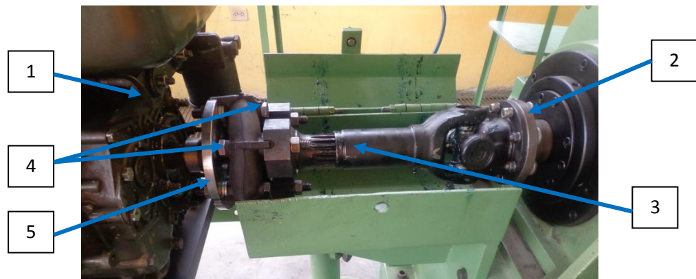
Figura 71. Acoplamiento del motor a prueba con el banco dinamométrico
