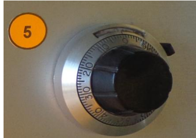
Figura 79. Potenciómetro de ajuste entre la corriente del freno y las RPM
