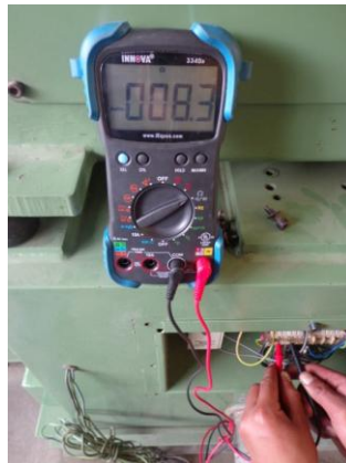
Figura 38. Comprobación del estator
