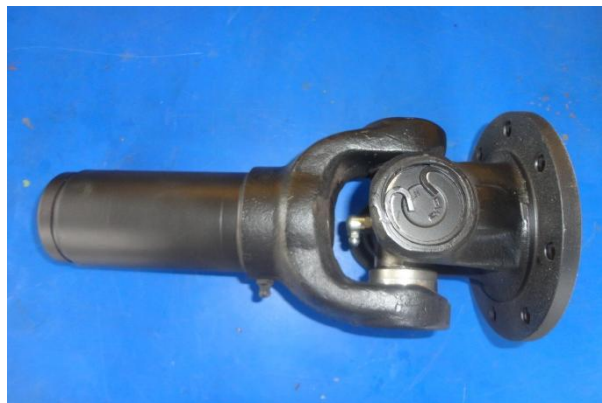
Figura 62. Eje cardán hembra realizado el mantenimiento
