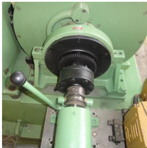
Figura 69. Palanca de accionamiento lubricada
