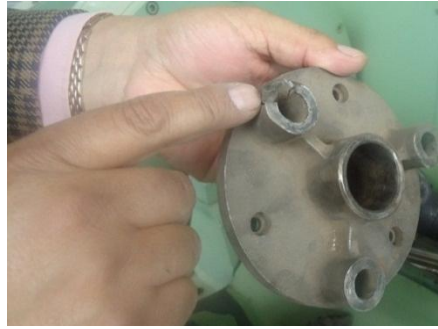
Figura 31. Acople metálico averiado
