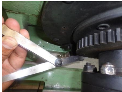
Figura 63. Calibración del sensor de revoluciones
