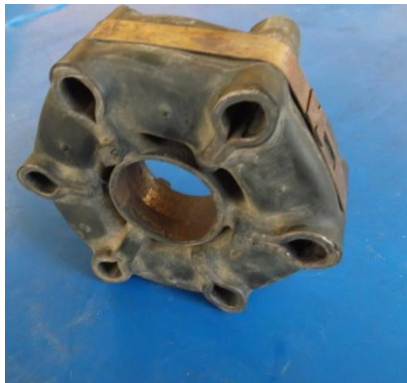
Figura 30. Acoplamiento flexible en pésimas condiciones
