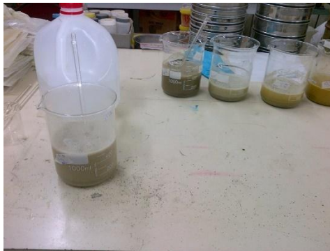
Figura 8 Eliminación de materia orgánica
