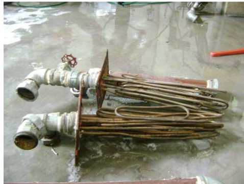
FIGURA 22. Serpentes del calentador actual
