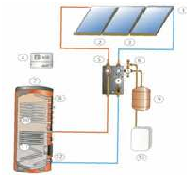
FIGURA 36. Esquema de instalación de paneles solares
