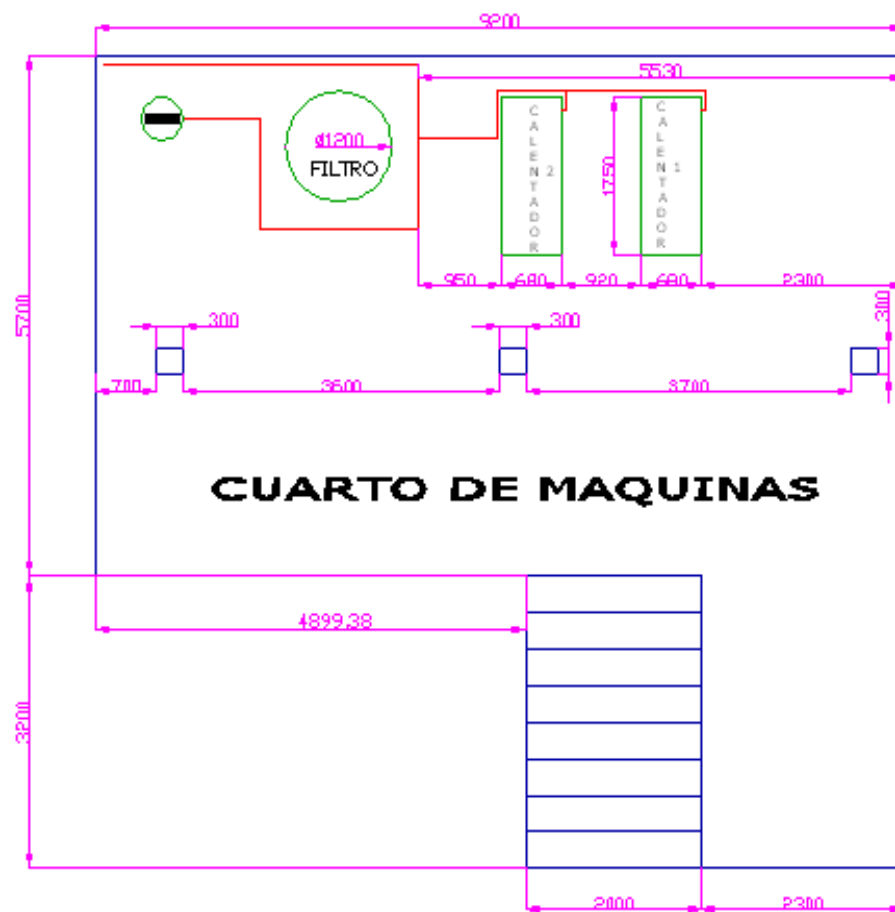
FIGURA 45. Dimensiones sala de máquinas
