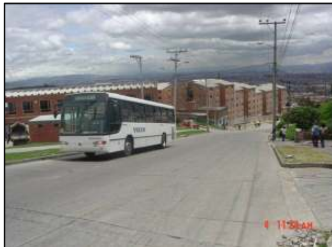
Figura 21 Autobús en Prueba de Arranque en Pendiente
