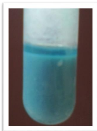
FOTOGRAFÍA No. 14. ENSAYO DE FEHLING (-) EN EXTRACTO ALCOHÓLICO
