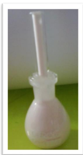
FOTOGRAFÍA No. 24. DETERMINACIÓN DE DENSIDAD RELATIVA. MÉTODO PICNOMÉTRICO
