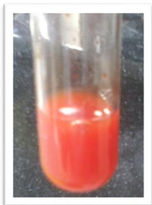
FOTOGRAFÍA No. 20. ENSAYO DE SUDÁN (+) EN EXTRACTO ETÉREO
