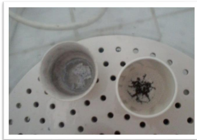
FOTOGRAFÍA No. 23. DETERMINACIÓN DE CENIZAS. MÉTODO DE INCINERACIÓN EN MUFLA
