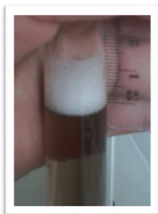
FOTOGRAFÍA No. 18. ENSAYO DE ESPUMA (+) EN EXTRACTO ACUOSO
