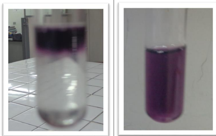
FOTOGRAFÍA No. 5. ENSAYO DE CLORURO FÉRRICO REALIZADO A LA DILUCIÓN DE ASA EN ACACIA/AGUA 1% DESPUÉS DE 24 HORAS DE PREPARACIÓN. COLOR VIOLETA, PRESENCIA DE ÁCIDO SALICÍLICO. REACCIÓN POSITIVA
