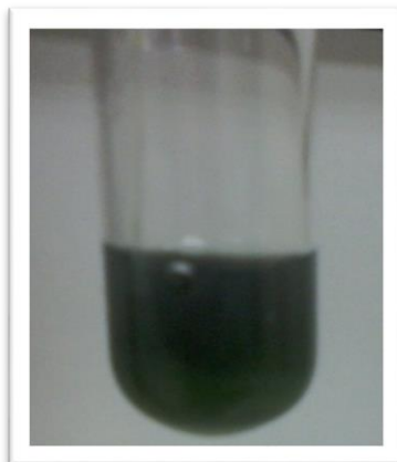
FOTOGRAFÍA No. 8. ENSAYO DE CLORURO FÉRRICO (+) EN EXTRACTO ALCOHÓLICO
