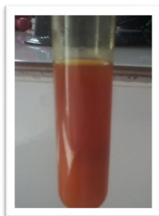
FOTOGRAFÍA No. 19. ENSAYO DE BALJET (+) EN EXTRACTO ETÉREO
