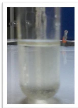
FOTOGRAFÍA No. 13. ENSAYO DE SHINODA (-) EN EXTRACTO ALCOHÓLICO
