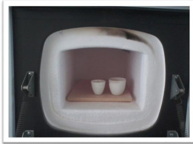
FOTOGRAFÍA No. 22. DETERMINACIÓN DE HUMEDAD. MÉTODO DE DESECACIÓN EN ESTUFA DE AIRE CALIENTE
