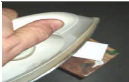
Figura 97. Planchado del diseño de circuito en la baquelita
