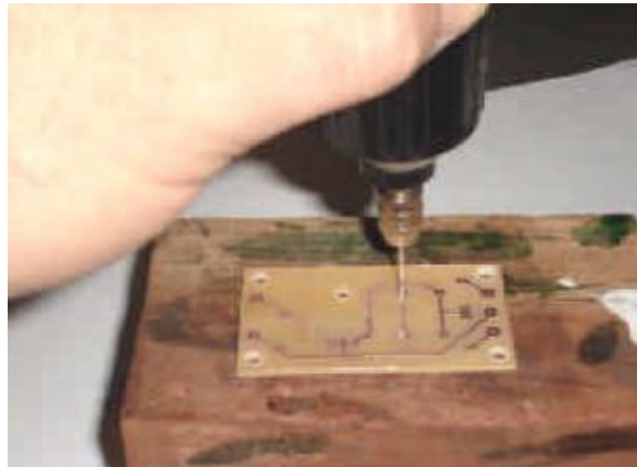
Figura 101. Realización de agujeros en la baquelita
