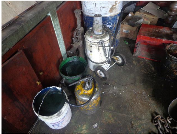
Figura 32. Inadecuado almacenamiento de lubricantes
