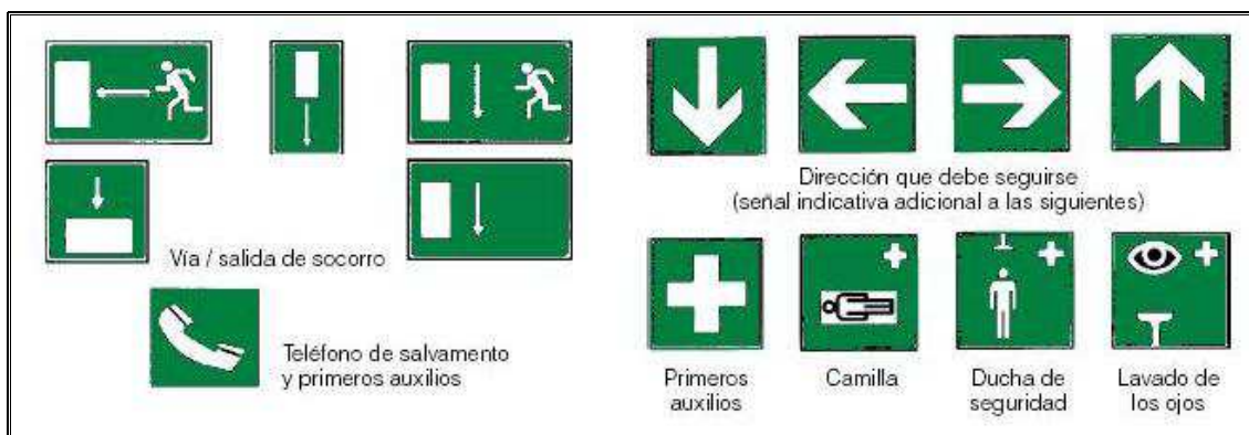
Figura 59. Señales de salida
