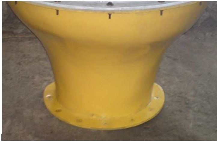
Figura 38. Zona de contracción terminada
