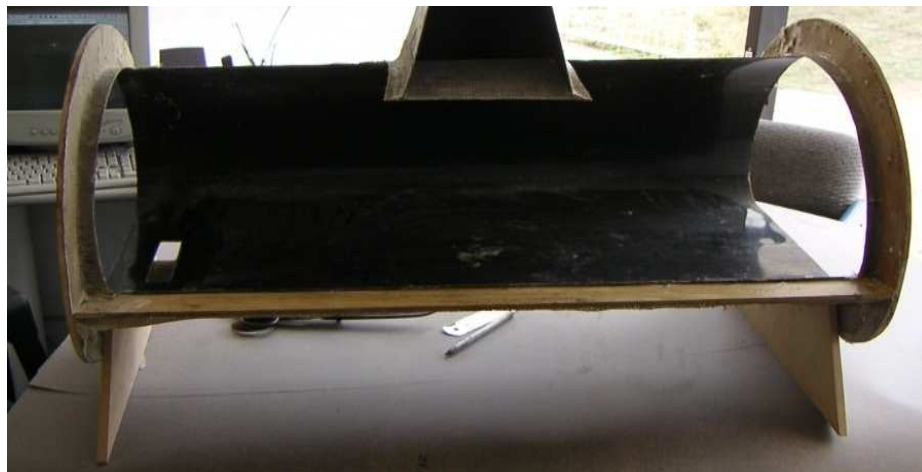
Figura 33. Construcción inicial de la zona de pruebas
