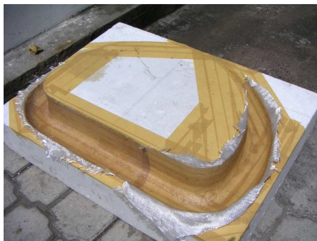
Figura 39. Proceso de construcción de la zona honeycombs.
