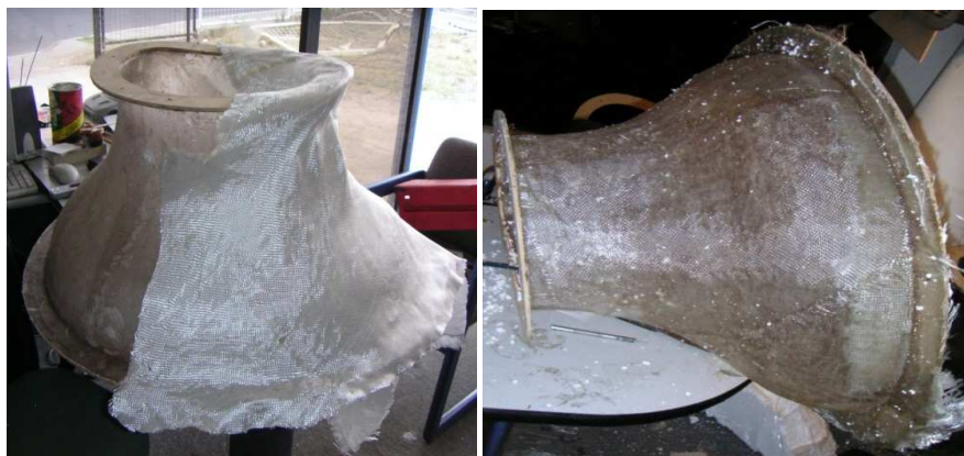
Figura 37. Proceso de construcción de la zona de contracción
