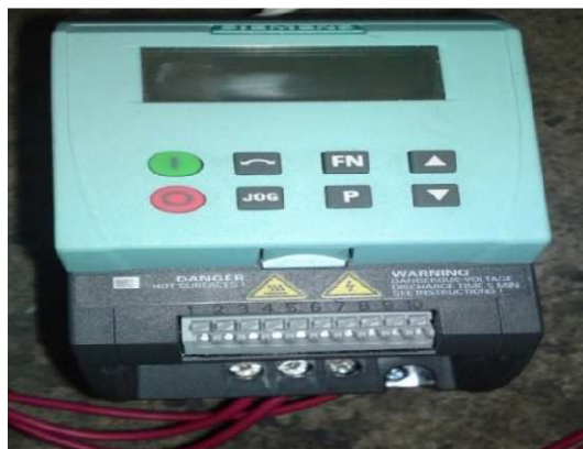
Figura 46. Variador de frecuencia
