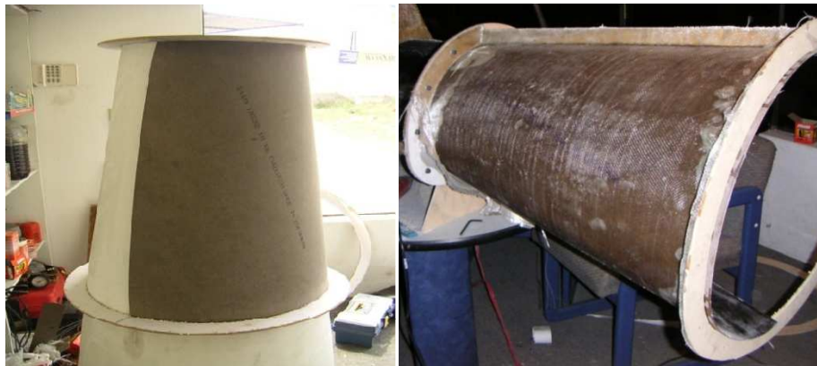
Figura 35. Proceso de construcción del difusor cónico
