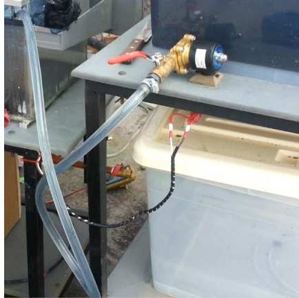
Fig. 16.Sistema de entrada de agua
