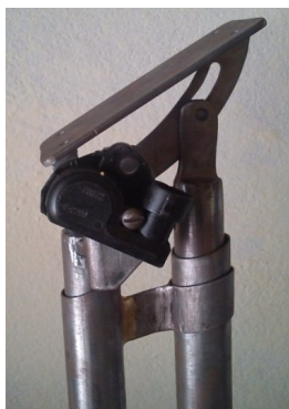
Figura 5.14 Adaptación del TPS en el mecanismo
