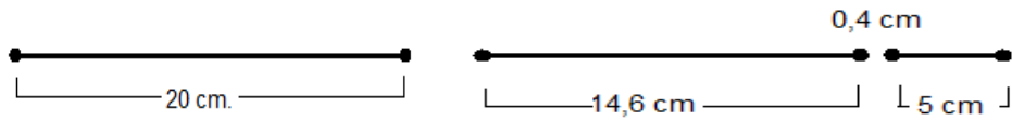
Figura 4.3 Alerón de un Flap y dos Flaps con la misma longitud de cuerda
