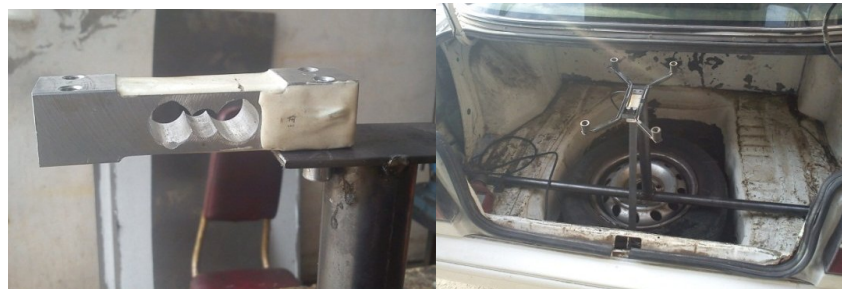
Figura 5.13 Instalación de la celda de carga en el vehículo
