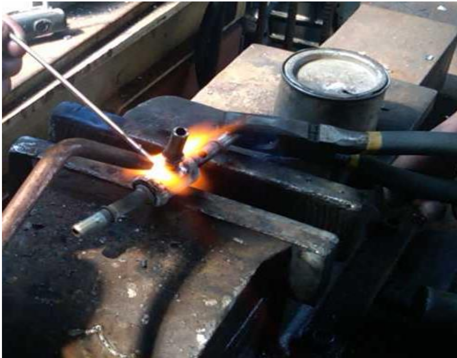
Figura 33. Proceso de soldadura de los caudalímetros
