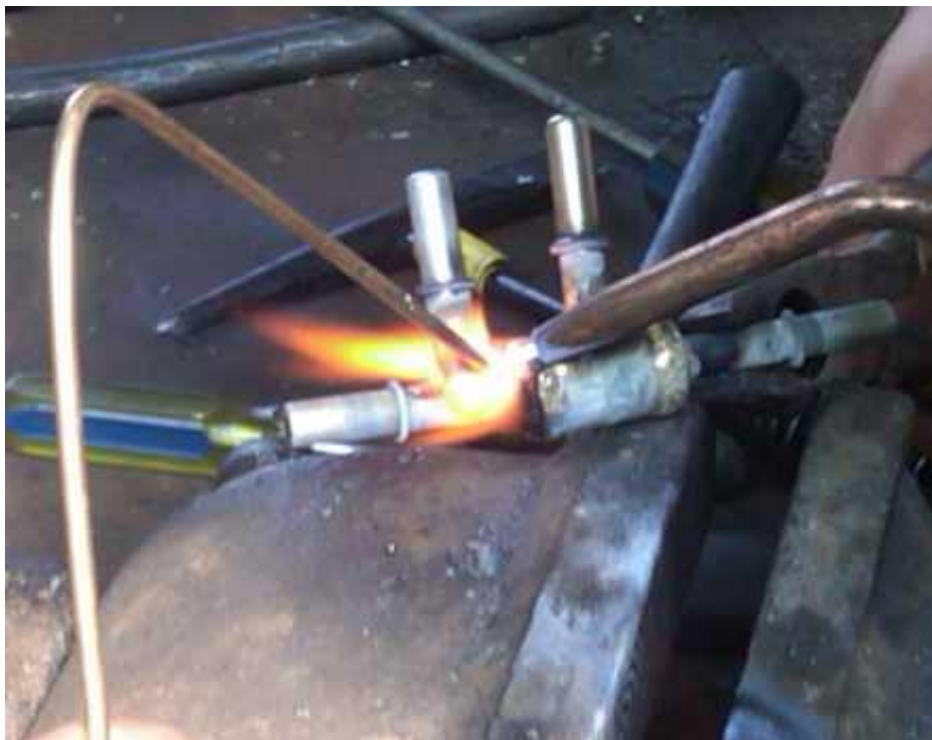
Figura 34. Finalización de la soldadura de los caudalímetros
