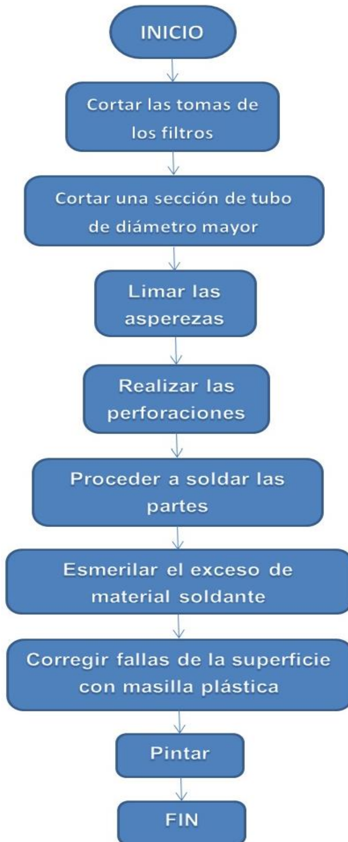
Figura 32. Proceso de construcción de los caudalímetros
