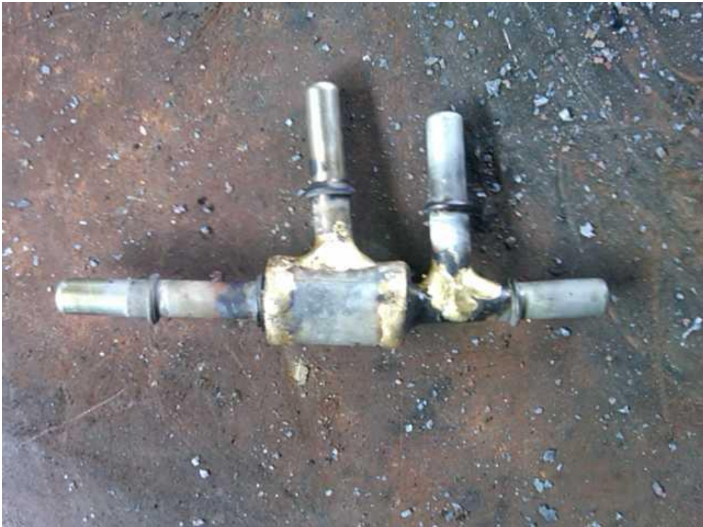
Figura 35. Caudalímetro soldado pero con sus tomas torcidas
