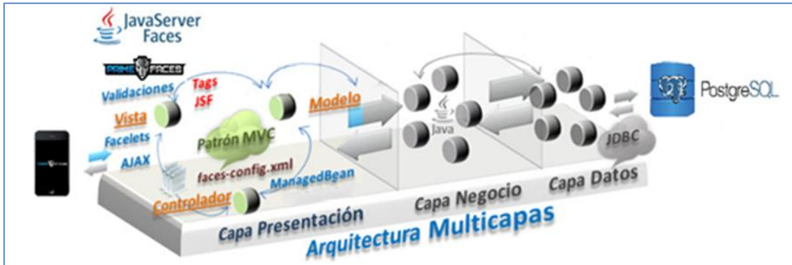
Figura V.10: Arquitectura de la aplicación web móvil
