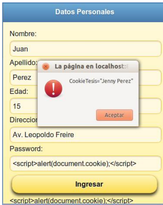
Figura II.14. Ejecución del script por la desactivación del filtro de escape.
