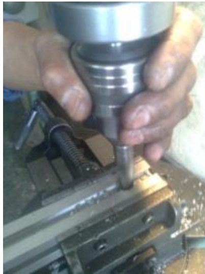
Figura IV. 78 Perforación de los perfiles de aluminio
