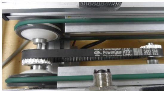
Figura IV. 84 Correa Power Grip y polea acoplada a la base de aluminio
