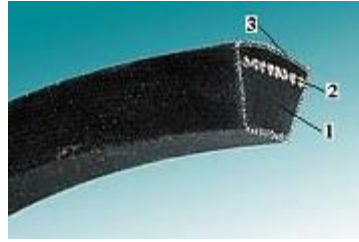
Figura II. 12 Elementos de una correa trapezoidal
