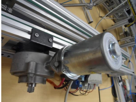
Figura IV. 82 Motor Mando Corporation 56300-1E500 acoplado a la estructura de aluminio
