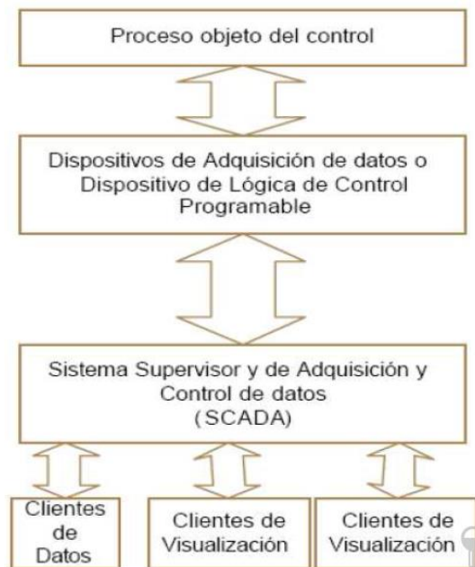
Figura II. 52 Esquema Básico de un sistema SCADA
