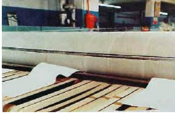
Figura II. 15 Banda transportadora en la industria de lavandería
