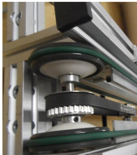
Figura IV. 83 Polea acoplada a la estructura de aluminio
