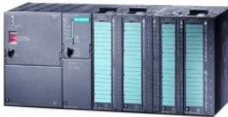
Figura III. 56 Módulos de un PLC
