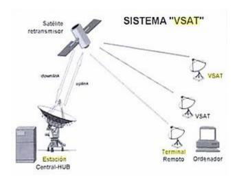
Figura III.35 Satélite con una Estación Terminal VSAT<sup>34</sup>
