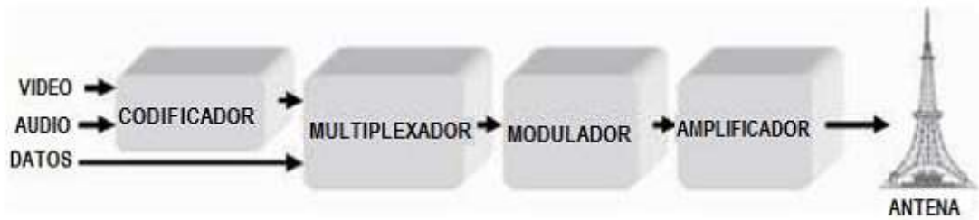
Figura II. 15. Sistema General de transmisión ISDB-Tb
