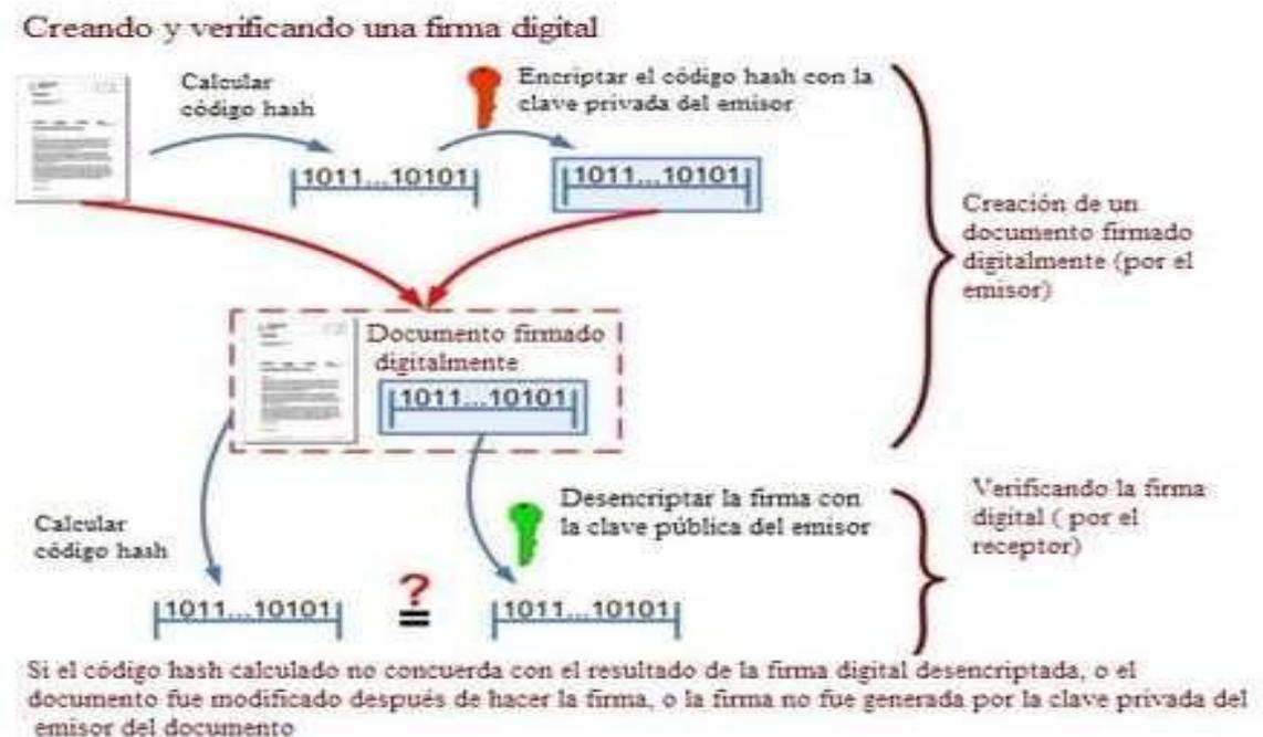
Figura II.8 Creación de una firma digital
