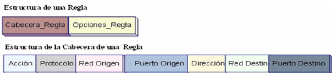
Figura II. 10. Estructura de una regla
