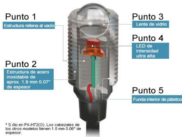
Figura III. 38 Disposición de un sensor Fotoeléctrico. 38
