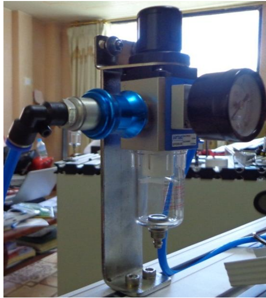
Figura V.84 Unidad de mantenimiento del sistema Neumático. 89
