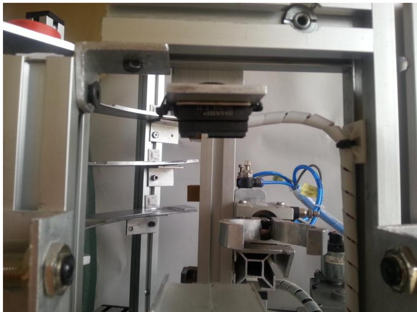
Figura VI.162 Montaje del sensor Sharp
