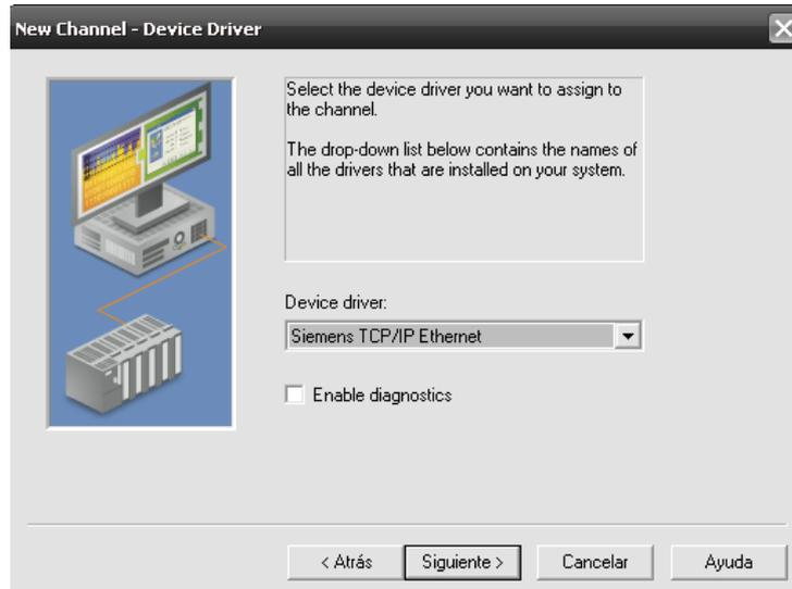
Figura VI.172 Seleccionamos el dispositivo Siemens
