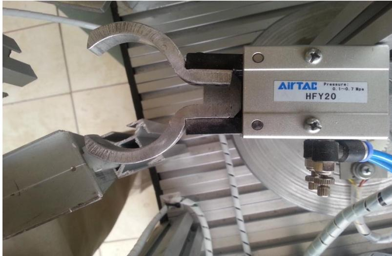
Figura VI.158 Pinza neumática
