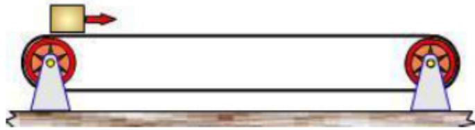
Figura III.105 Movimiento lineal continuo
