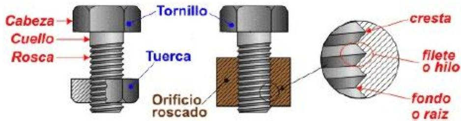
Figura III.99 Partes del tornillo
