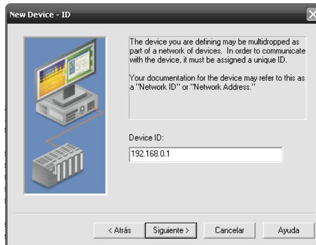
Figura VI.179 Agregar la dirección 192.168.0.1 del PLC
