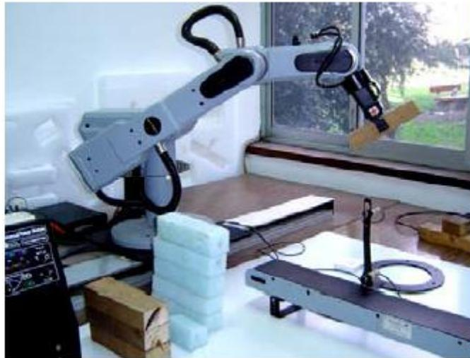
Figura III.48 Brazo Robótico controlado para Mover figuras
