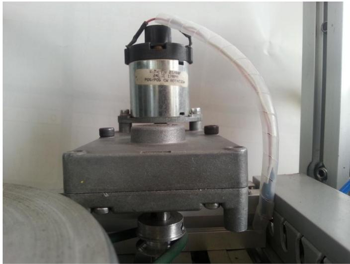
Figura VI.154 Montaje del motor 1 eléctrico de engranaje 24 Vdc
