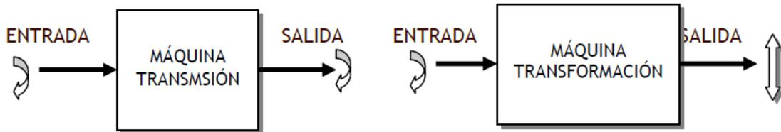
Figura III.128 Sistemas De Transformación Del Movimiento
