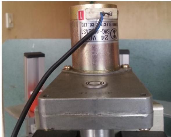
Figura VI.155 Montaje del motor 2 eléctrico de engranaje 24 Vdc
