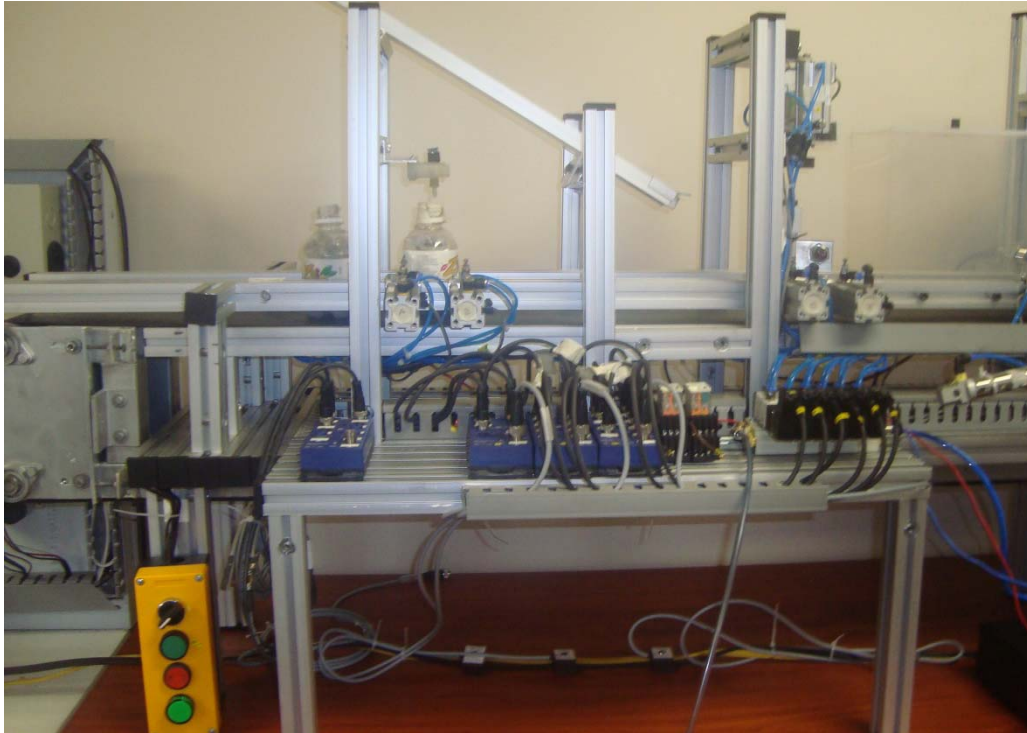
Figura IV.57 Modulo del proceso del llenado de líquido con tecnología ASi 68 Por lo que haremos una comparación del cableado tradicional con la tecnología.
