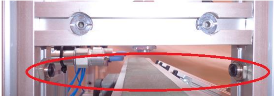
Figura V.55 Montaje del sensor óptico.
