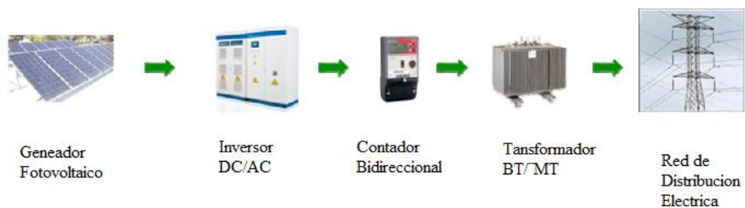
Figura III-4 Componentes de una instalación conectada a la red
