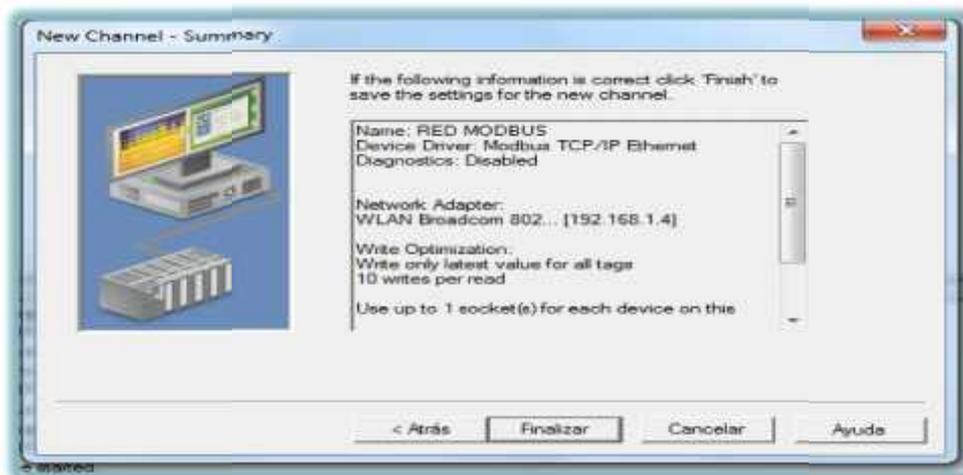
Figura V. 5 Pantalla de resumen de la configuración del canal
