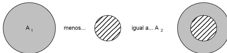
**Fig. II.23. Diferencia entre las secciones efectivas de un cilindro.**
