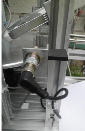
**Fig. III.51 Montaje del sensor óptico.**
