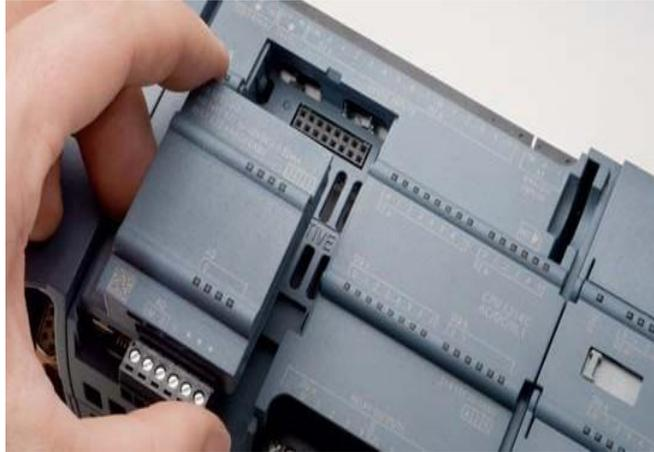
**Fig. II.9 Módulos de comunicación**
