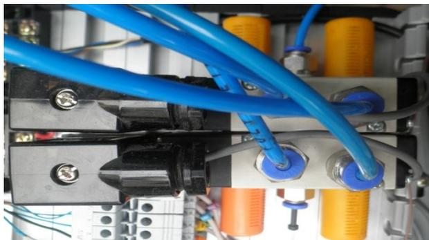
**Fig. III.48 Bloque de válvulas de distribución.**
