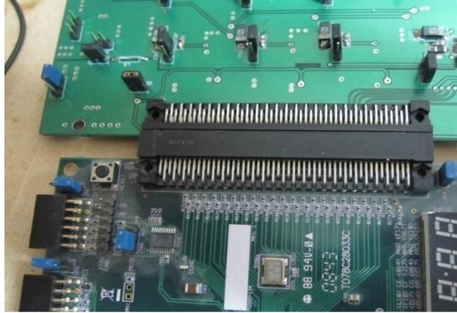
**Figura V.5 Conexión entre la Nexys y la digitalizadora mediante el conector Hirose**
