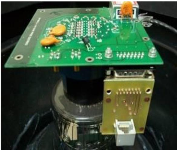
**Figura IV.15** Placa RJ-45 a DB15
