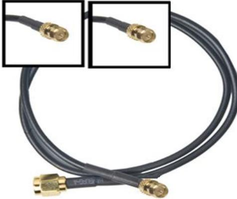
**Figura IV.14** Cable para conexión entre conectores SMA hembra de la base y la digitalizadora
