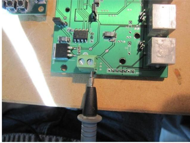
**Figura V.7** Conexión a tierra del multímetro para realizar las respectivas mediciones
