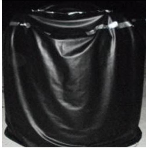
**Figura IV.3 Tanque cubierto exteriormente por blackout y plástico negro**
