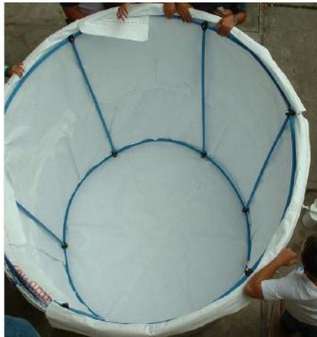
Figura IV.2 TYVEK en una estructura de tubo pvc para ubicar dentro del tanque
