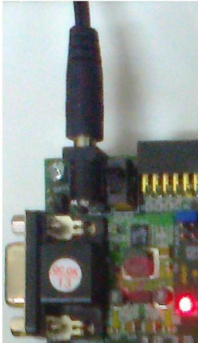
**Figura V.6 Conexión de 12V a la nexys 2**
