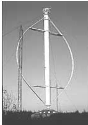
**Figura III.18 Turbina eólica de eje vertical**
